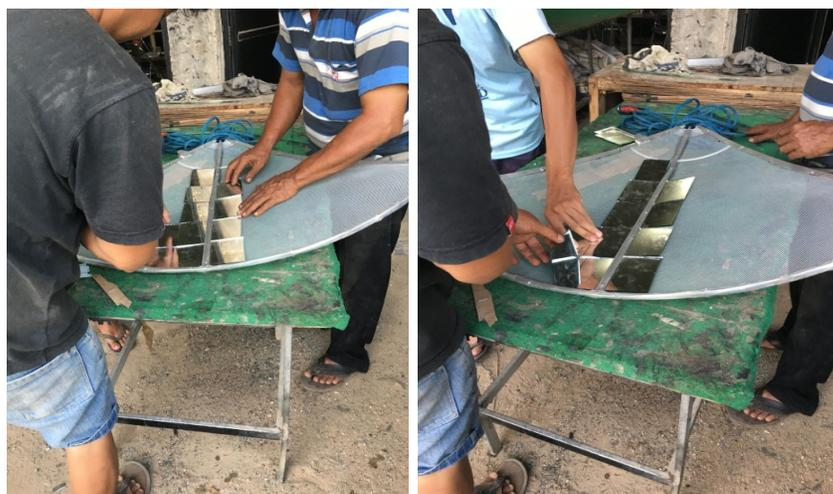
**Gambar 4. Pemasangan Cermin pada Rangka Parabola**
