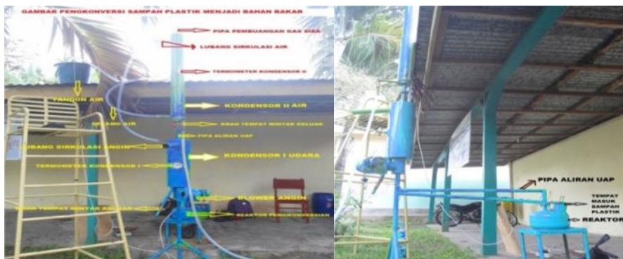
Gambar 2. Rangkaian alat pirolisis pengonversi sampah plastik menjadi bahan bakar
